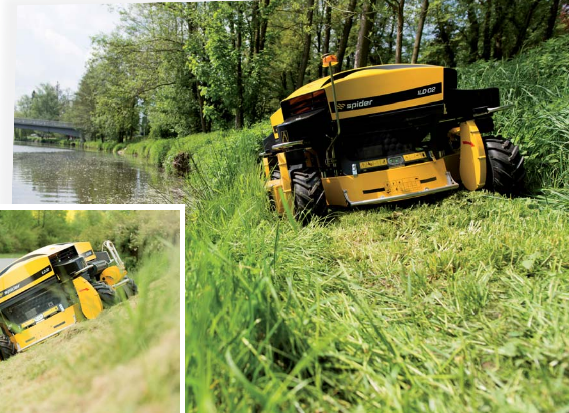
Dálkově řízené sekačky Spider ILD02 se uplatní při extenzivní a intenzivní údržbě zeleně ve svazích i na rovině. Jako doma jsou v okolí silnic a vodotečí
